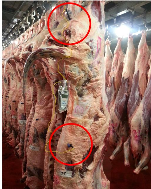
[그림 5] 소 좌반도체의 등심 및 우둔 데이터로거 장착
