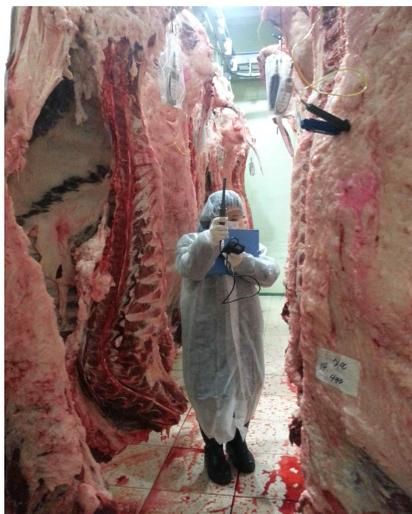
[그림 8] 예냉실내 공기온도 및 습도 측정
