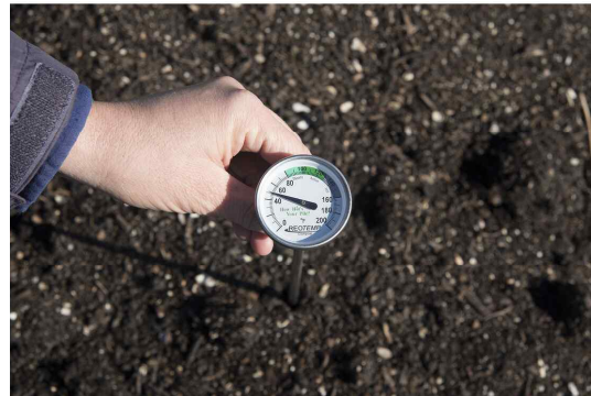
<그림 4-2> 퇴비더미 온도 측정용 바이메탈 온도계
