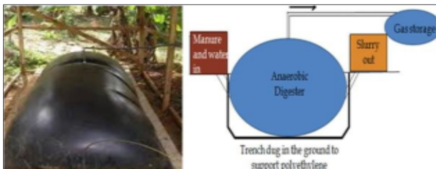
그림 64. 분뇨처리기술 - 폴리에틸렌 백 소화조 외관과 모식도
