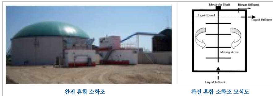
그림 57. 분뇨처리기술 - 완전 혼합 소화조의 외관과 모식도
